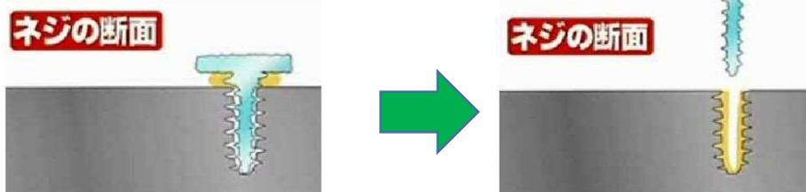
①スプレー効果を利用して金属を急激に冷却する事で金属が縮む特性を利用。
